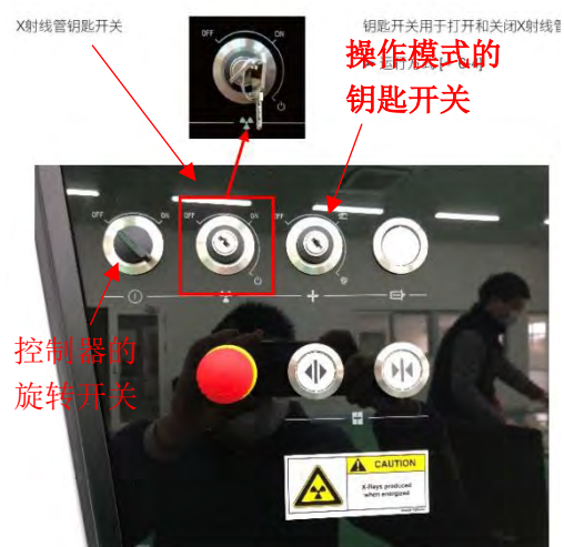
图 10-7.5 X 射线管的钥匙开关、控制器的旋转开关、操作模式的钥匙开关、急停按钮
