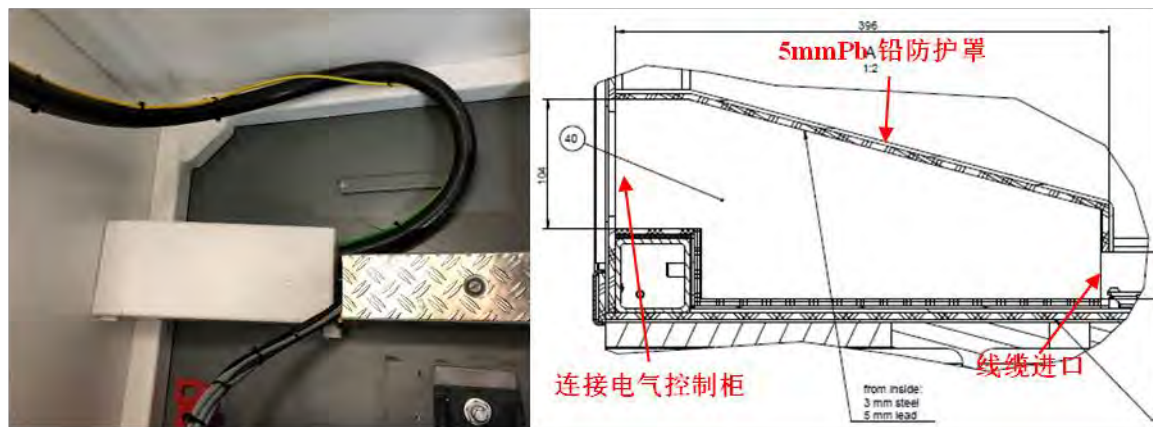
图 10-6 穿线孔屏蔽设计图
