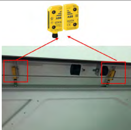
图 10-7.2 门机联锁装置
